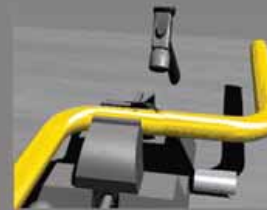
ÍTEM 21 Codo Estándar Plegado de Equilibrio (masa 1.8kg) Use 2 Codos del ÍTEM 20 para fabricar.
